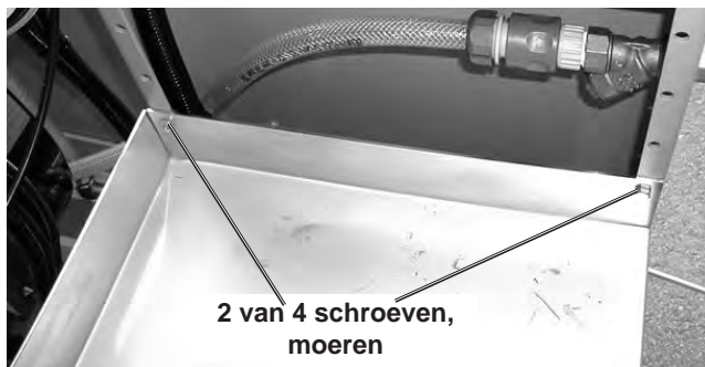
Afbeelding 6.15 CF-2116 D Montagekast rechts; zicht op de waterreservoirconsole (waterreservoir verwijderd)
