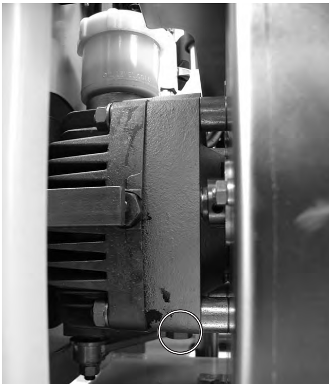
Afbeelding 6.10 CF•2116 D, olieaftapschroef onder het hydrostatische voortstuwingsdrijfwerk
