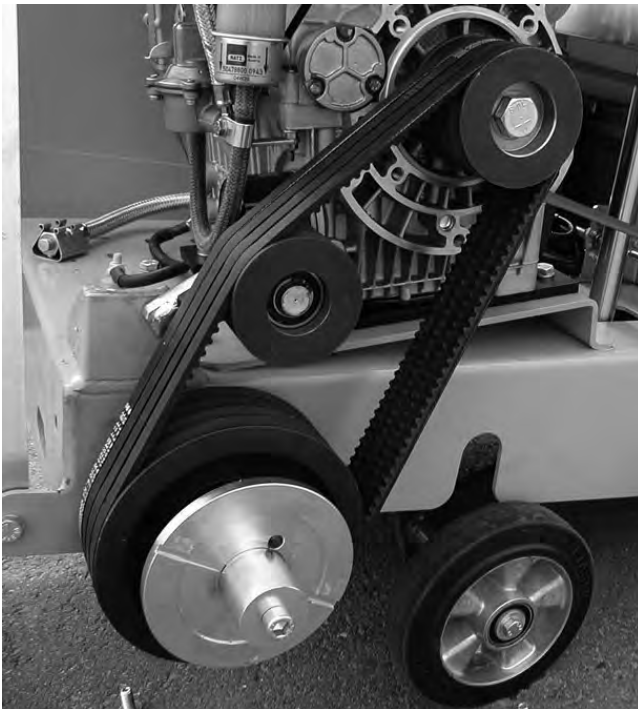
Afbeelding 6.6 CF-2116 D, snijas-V-riemen
