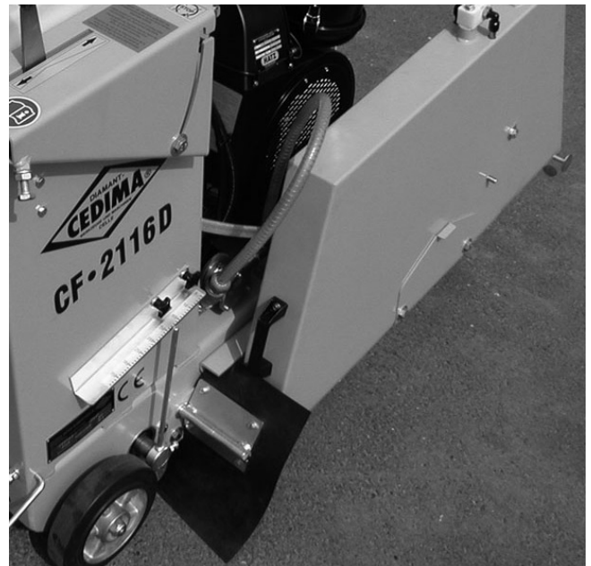
Afbeelding 1.2 CF-2116 D (standaard) met opgeklapte bladbeveiliging
