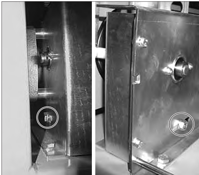
Afbeelding 6.20 Behuizing voortstuwingsdrijfwerk, zicht op de linker en rechter moer van het kettingspanwiel
