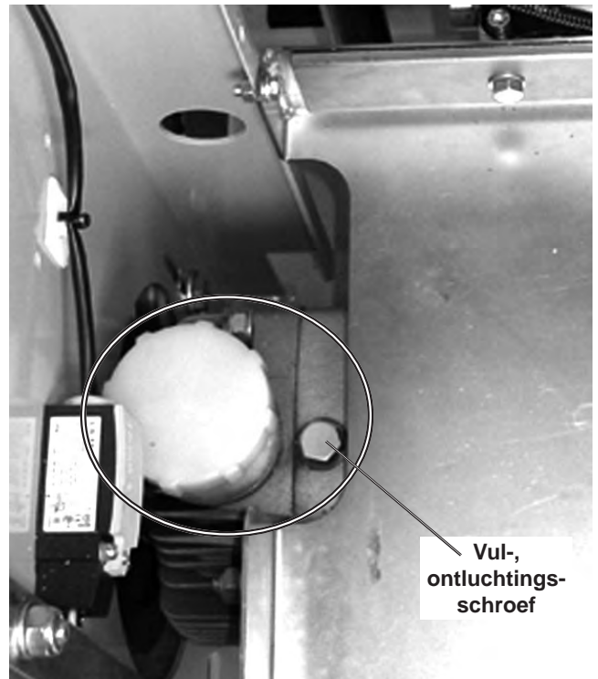
Afbeelding 6.9 CF-2116 D, hydrostatisch voortstuwingsdrijfwerk (waterreservoir verwijderd)
