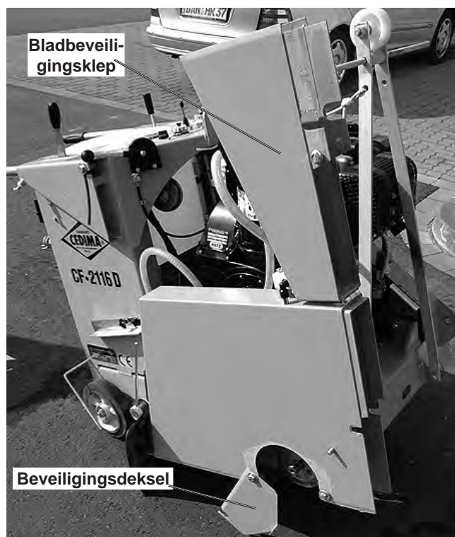
Afbeelding 4.18 CF-2116 D Standaard, bladbeveiliging (rechts gemonteerd), bladbeveiligingsklep geopend en beveiligingsdeksel opengezwenkt
