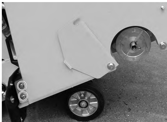
Afbeelding 4.26 Bladbeveiligings-bevestigingsschroeven aan de rechterkant van de CF-2116 D Standaard
