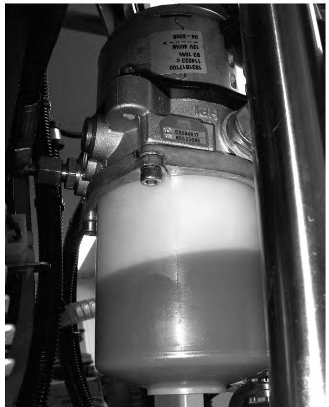
Afbeelding 6.12 Het peil van de hydraulische vloeistof in de transparante verzameltank van het elektro-hydraulische compacte aggregaat bij de CF-2116 D
