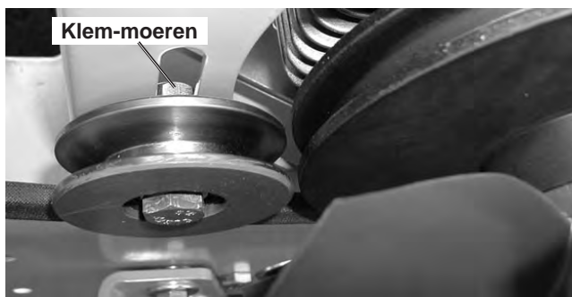
Afbeelding 6.8 CF•2116 D, voortstuwings-V-riem-spanrol, V-riem-spanrol, V-riembeschermingsdeksel gedemonteerd
