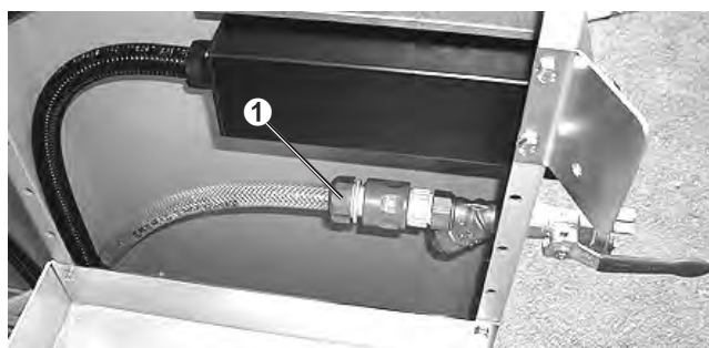
Afbeelding 4.37 CF-2116 D, waterreservoir verwijderd, bladbeveiligings-slang ① van de drukaansluiting loskoppelen
