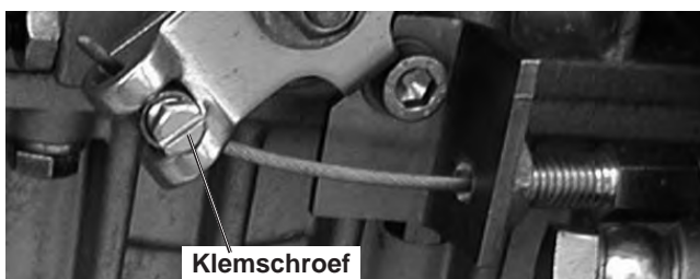
Afbeelding 6.25 CF-2116 D, toerentalhendel met bowdenkabel aan de motor
