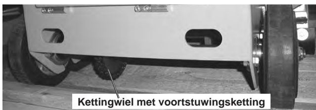
Afbeelding 6.18 Achterkant voegensnijder, zicht op de aandrijvingsas
