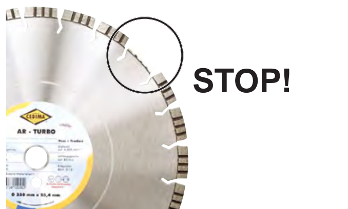
Defect, klapperend niet rond lopend diamantzaagblad met ontbrekende segmenten vervangen
