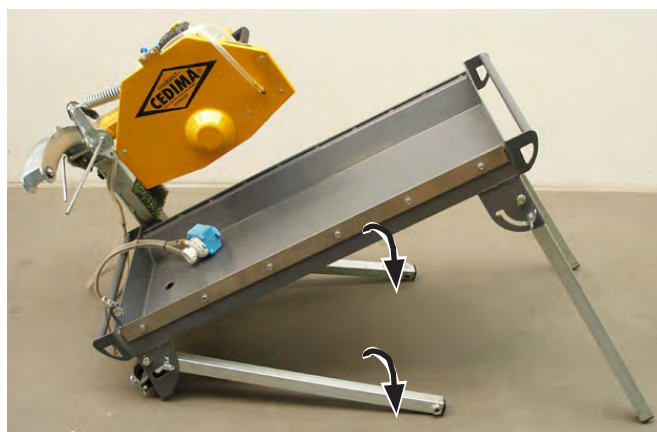
Tweede standvoetenpaar vergrendelen en wegdraaien
