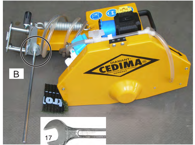
Houder voor sproeibescheringskap met tegenmoer en schijf demonteren Afbeelding 5.22
