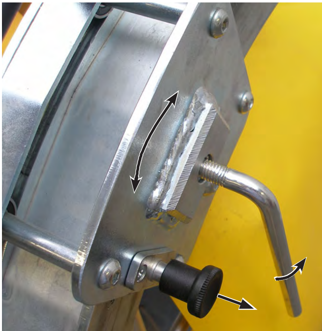
Uitgetrokken vergrendelingspinnen en losgemaakte klemgreep aan de geleidingsleden Afbeelding 4.40
