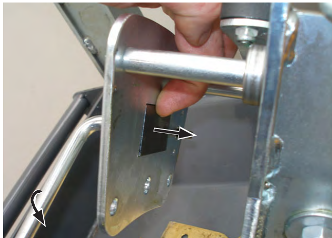
De drukplaat met de klemgreep uitdrukken
