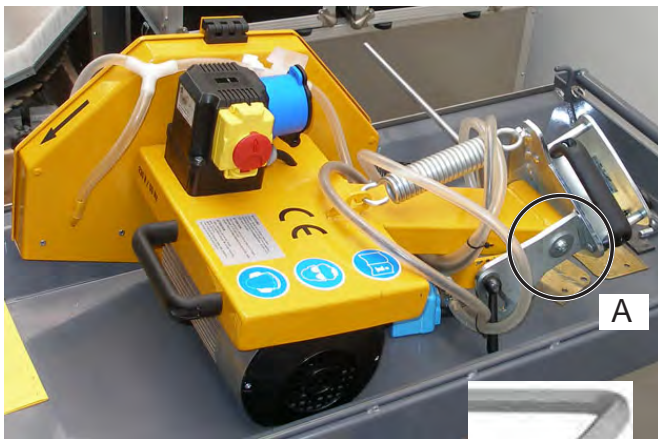
Schroef met vlakke kop met schijf demonteren Afbeelding 5.21
