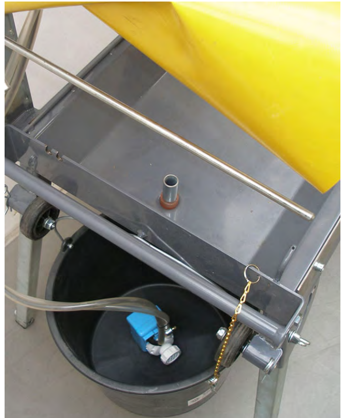
Overloopstoppen in afvoer van de waterkuip, waterpomp in de bouwemmer aan het tafelzaagframe
