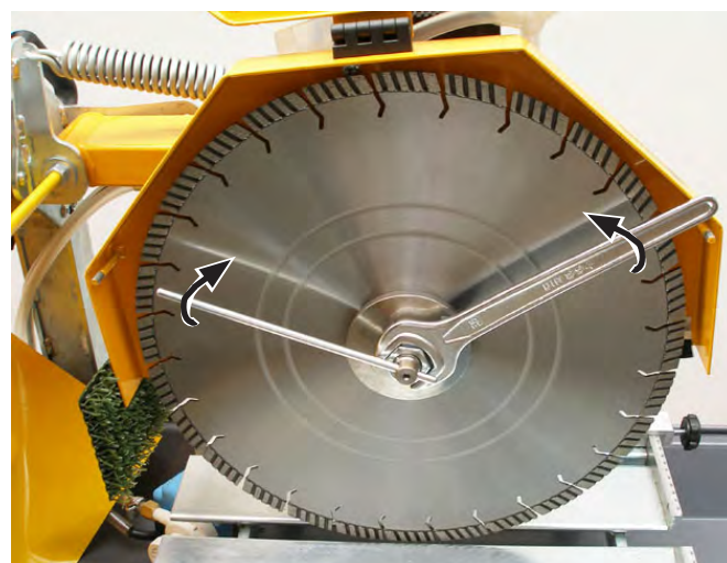
Drukflens met de snijasmoer aan het diamantzaagblad spannen
