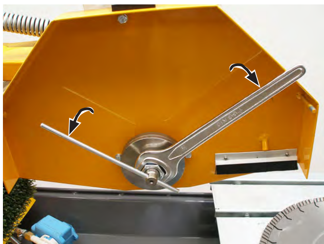
Snijas- (span-)moer lossen
