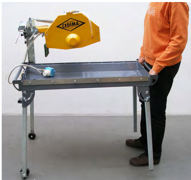
Transport van de tafelzaag met aan de standvoeten gemonteerde rollen; roltafel gedemonteerd
