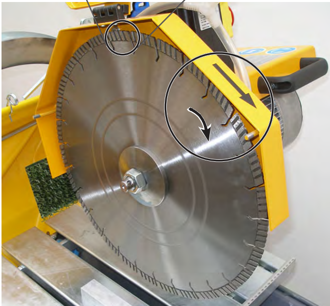
Diamantzaagblad met de snijrichting van de diamantsegmenten overeenkomstig de draairichting van de snijas monteren Afbeelding 4.31
