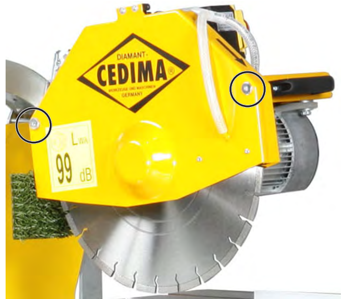
Zaagbladbescherming sluiten en met de ronde moeren beveiligen
