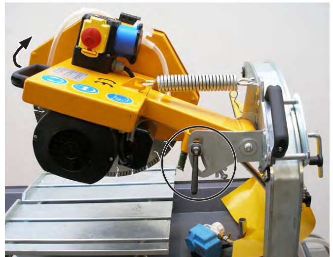
Kegelgreep lossen en de pendelsnijarm vasthouden
