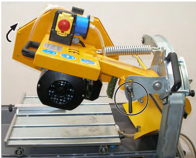
Pendelsnijarm uitheffen en met de kegelgreep arreteren Afbeelding 4.23
