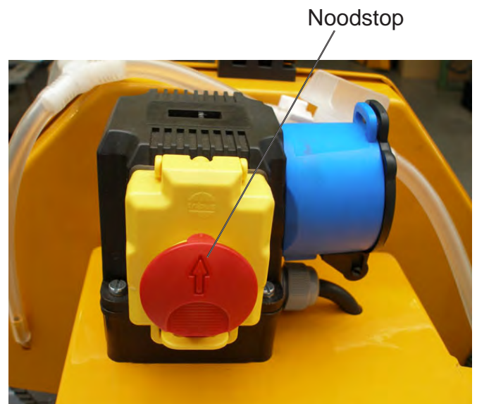
AAN/UIT, noodstop-schakelaar, klep gesloten
