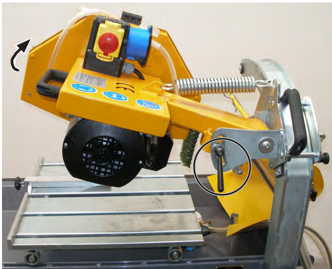
Pendelsnijarm uitheffen en met kegelgreep arreteren Afbeelding 5.9
