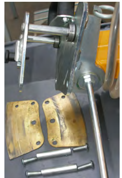
De beide onderste stiften gedemonteerd en de beide glijplaten afgenomen Afbeelding 5.16
