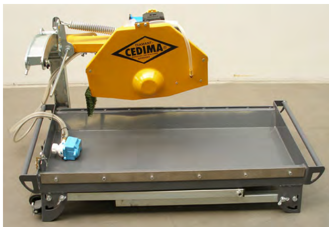
Roltafel en accessoires verwijderd
