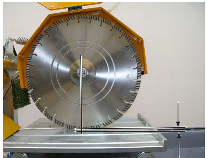
Pendelsnijarm (zaagblad) op de maximale snijdiepte ingesteld
