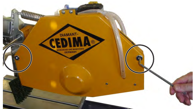
Ronde moeren en zaagbladbescherming losmaken Afbeelding 4.24
