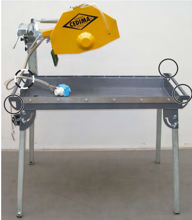
Kraanogen aan de greepbuizen van de CTS•57 G, roltafel en zaagblad gedemonteerd Afbeelding 6.6
