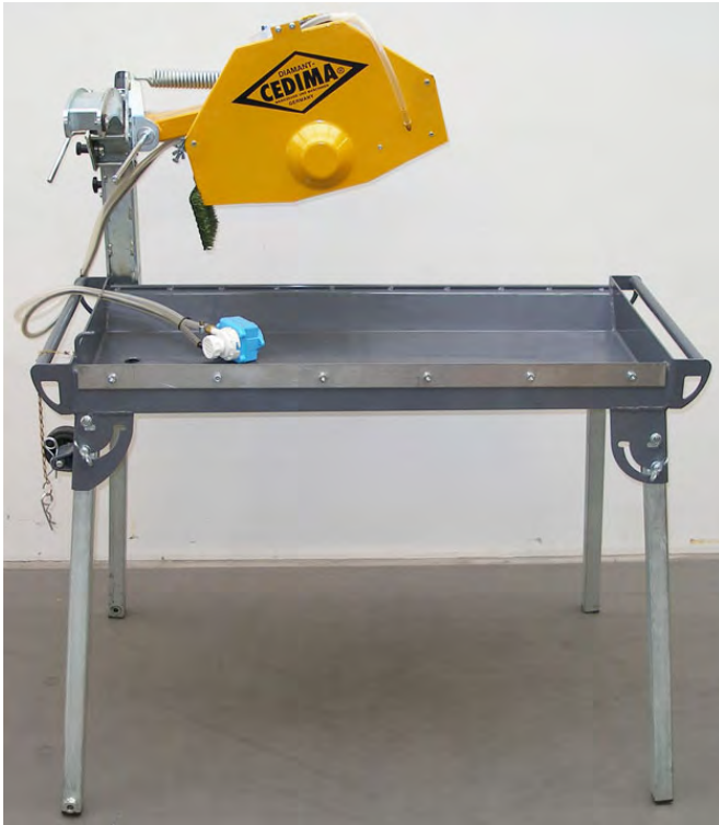
Tweede standvoetenpaar weggedraaid (tafelzaag opgesteld) Afbeelding 4.11
