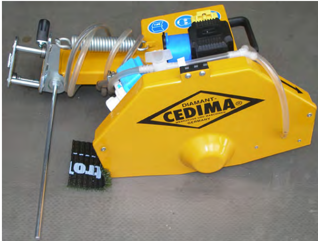
Geleidingssleden met pendelsnijarm en waterpomp gedemon- teerd Afbeelding 5.13
