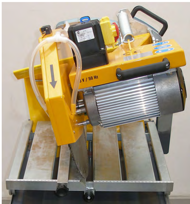
Geleidingsleden met vergrendelingspinnen (15° vergrendeling) en klemgreep vastgelegd Afbelding 4.43
