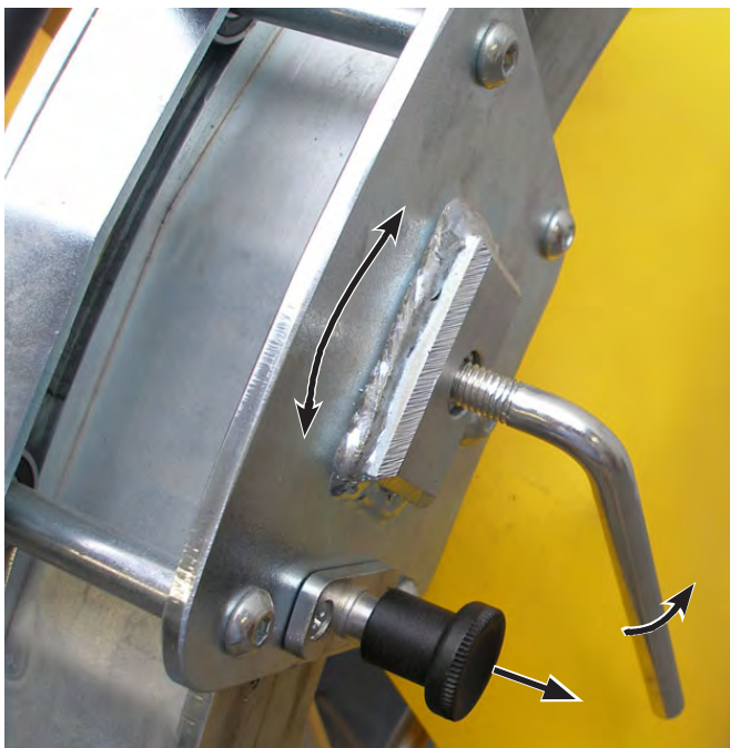
Uitgetrokken vergrendelingspinnen en losgemaakte klemhendel aan de geleidingssleden Afbeelding 5.10
