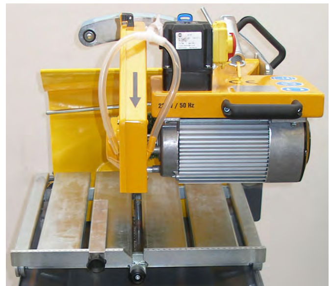
Geleidingsleden met vergrendelingspinnen (0° vergrendeling) en klemgreep vastgelegd Afbeelding 4.42
