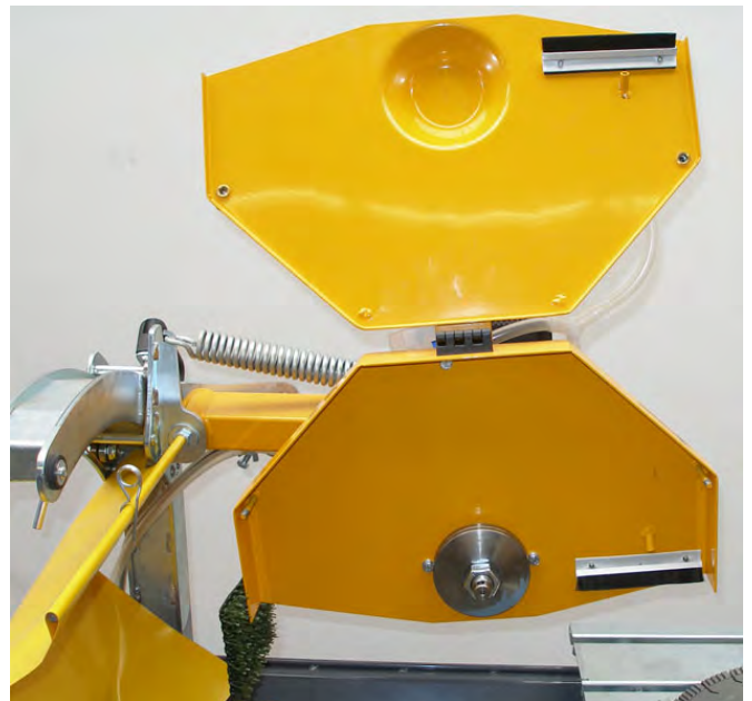
Zaagbladbeschermingsdeksel opklappen Afbeelding 4.25
