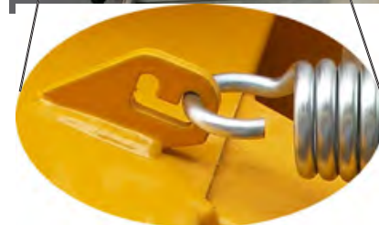
Pendelsnijarmveer, al naargelang de veerspanning, in de 1ste of 2de haken hangen Afbeelding 4.14
