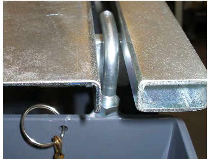
Roltafeltransportbeveiliging op de roltafel uitgericht
