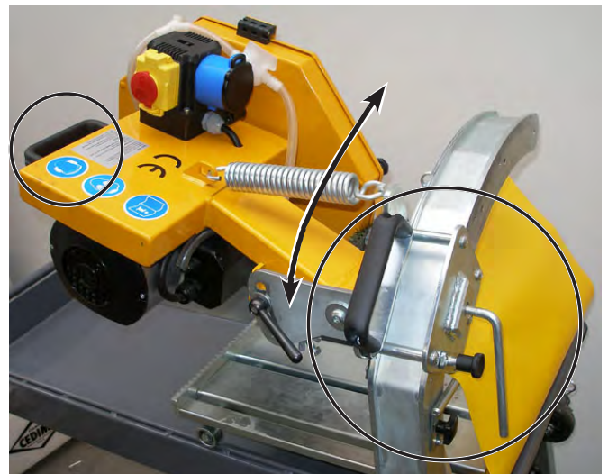
Geleidingssleden voor het draaien van de pendelsnijarm voor versteksnedden; greep voor het draaien Afbeelding 4.38
