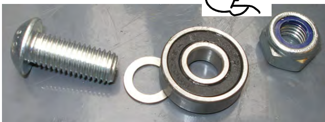
Onderste lager met passchijf gedemonteerd Afbeelding 5.14
